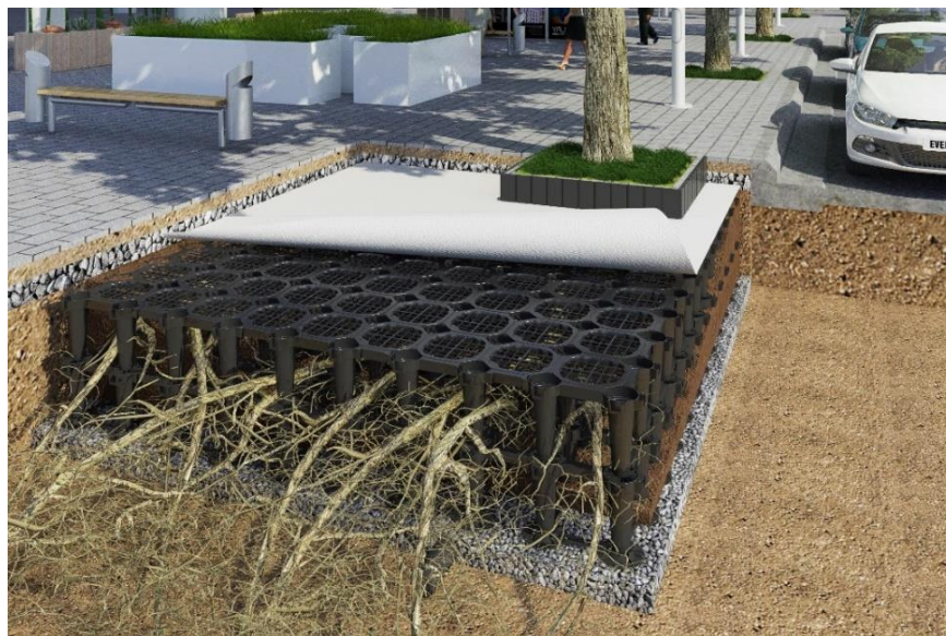
Figura 2. Exemplo esquemático da aplicação de um Sistema Modular para Suporte de pavimento (“Soil Cells”)
